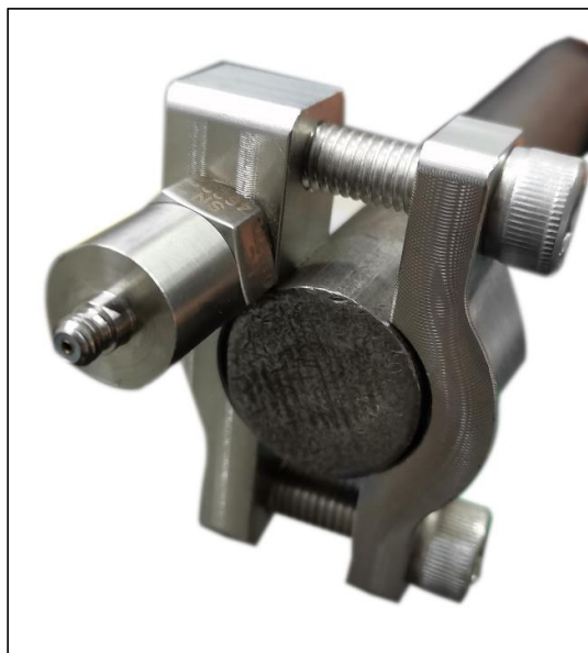
图2-2 锚杆锚索检测检测示意图
